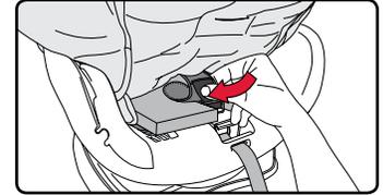
3. Deslice el dispositivo de retención de la hebilla en la ranura frontal de esta y en la posición para abrochar correspondiente; es importante que el botón rojo de desbloqueo quede hacia fuera. Remplace la cubierta.
