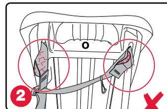
**IMPORTANTE:** Deje de utilizar el asiento para niños si este ha estado involucrado en un accidente moderado o grave, independientemente de que se hayan retirado las correas a través de la parte posterior del armazón y las puntadas de color hayan sido rasgadas.
