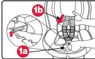
2. Presione el regulador de altura del arnés, deslice el arnés hasta la posición deseada y suelte.
