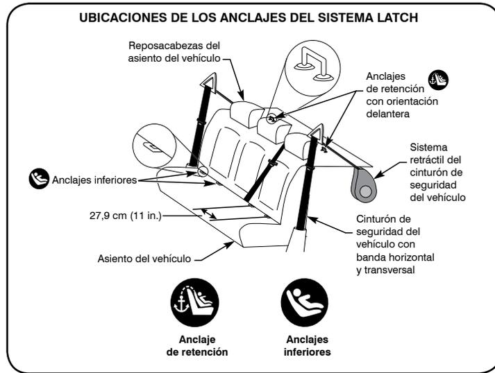
Consulte el manual del propietario de su vehículo para saber si está equipado con el sistema LATCH, el peso máximo de los anclajes inferiores, las capacidades de los anclajes de correa y la información sobre las posiciones disponibles de los anclajes inferiores y de los asientos para su uso con este asiento para niños.
