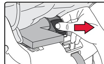
4. Jale el extremo de la almohadilla abdominal y la hebilla de retención de la ranura de la hebilla en la cubierta para remover.
