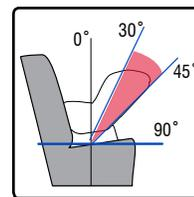
Utilice la línea azul como guía a fin de obtener el ángulo de inclinación adecuado para instalar asientos con orientación trasera. La línea azul deberá quedar paralela al suelo cuando el ángulo del asiento de seguridad para niños esté en el centro del intervalo comprendido (37,5). De ser necesario, el ángulo correcto de inclinación se puede lograr colocando una toalla enrollada o un flotador circular en la unión del respaldo y la parte inferior del asiento.
