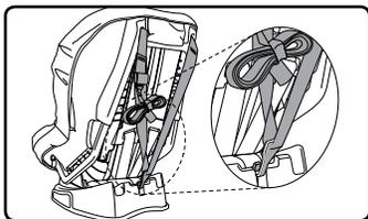
**NOTA:** El enganche de transporte de la correa de retención solo debe utilizarse cuando se desee transportar el asiento de seguridad para niños a otro lugar. Cuando se esté utilizando la correa para transportar el asiento, ajústela para una sujeción cómoda. **No instale el asiento de seguridad para niños con la correa de retención acoplado al enganche de transporte.**
