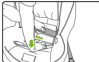
**IMPORTANTE:** Cabe la posibilidad de que el asiento de seguridad para niños no funcione de modo adecuado si la base del mismo no descansa de forma completamente horizontal sobre el asiento del vehículo.
