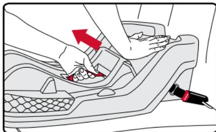
5. Deslice el exceso de la correa en la base hasta que las correas estén al nivel de la base.
