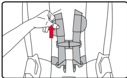
2. Afloje el arnés del asiento de seguridad para bebés pulsando el palanca de ajuste del arnés y jalando adelante ambas correas del correas.
