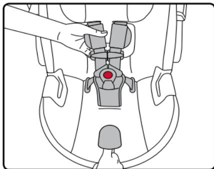
2. Busque el gancho de correa de la hebilla en la parte inferior del asiento de seguridad para bebés. Deslice una correa del arnés del gancho.
