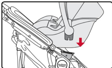
3. Tire hacia arriba de ambos lados del asiento de vehículo para bebés a fin de verificar el ajuste.
