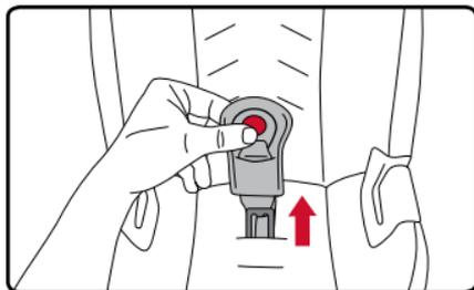
5. Jale la pestaña para quitar la cubierta y aflojar la cubierta.
