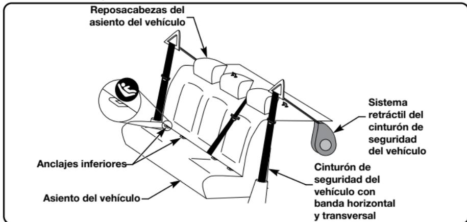
Consulte el manual del propietario de su vehículo para saber si está equipado con anclajes inferiores, el peso máximo de los anclajes inferiores y la información sobre las posiciones disponibles de los anclajes inferiores y de los asientos para su uso con este asiento para niños.
