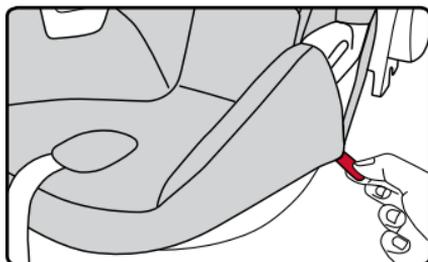
6. Jale el elástico para retirar la cubierta de las guías del cinturón por el asiento sin la base.
