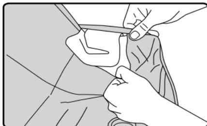
7. Jale la cubierta del alrededor del botón de ajuste del arnés y levante la cubierta fuera del exterior del asiento.
