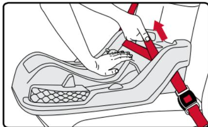
4. Mantenga el cinturón del vehículo transversal apretado y deslice firmemente bajo del seguro en el lado opuesto de la base de la hebilla.
