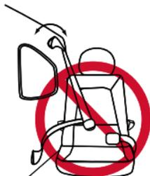
Cinturones sobre el hombro y la cadera con puntos de anclaje superiores o inferiores en la puerta del vehículo.
