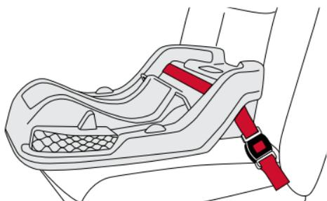
Instalación del base con cinturón de banda horizontal
