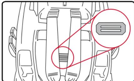
3. Jale el retenedor de correa de la hebilla, alejándolo del asiento para aflojar, y gire el retenedor de correa de la hebilla de modo que el lado corto pasará a través de la ranura del exterior del asiento y la cubierta.
