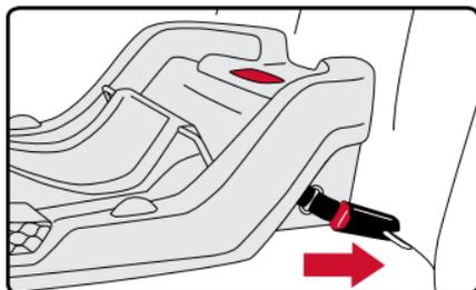
4. Mientras presiona la base sobre el asiento, jale de la correa de ajuste de los conectores inferiores para apretar.
