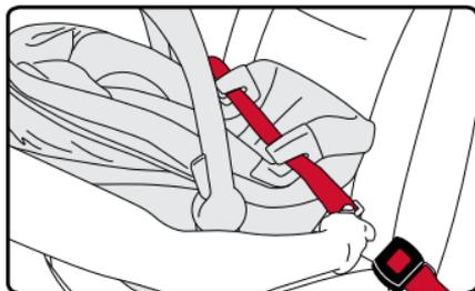
4. Compruebe que el cinturón del vehículo no esté torcido y abróchelo. Bloquear el sistema de cinturones de seguridad del vehículo según las instrucciones de su manual del propietario del vehículo.
