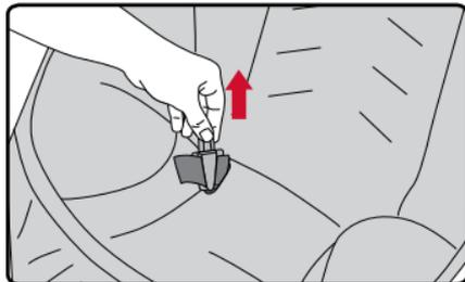
3. Tire de la correa de ajuste del arnés a través de la cubierta.
